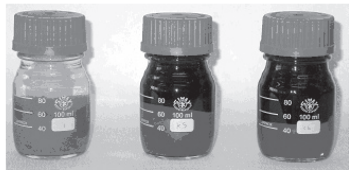
Figur 1: Red cap flasker benyttet til laboratorieforsøg. Der blev tilsat 80 g sediment og ca. 100 ml væske, indtil flasken var fyldt.
