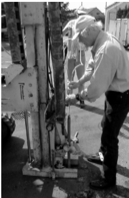
Figur 3. Installation indvendigt i 1,25" GeoProbe rør.
