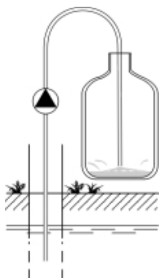
Figur 1 Prøvetagning for metan ved den metode, som traditionelt anvendes i Danmark.
