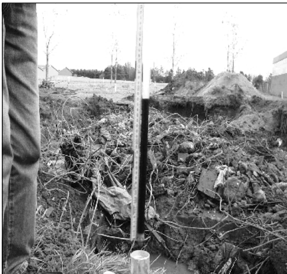
Figur 2. Fri fase af trichlorethylen ved hot-spot. Den sorte farve skyldes et betydeligt olieindhold.
