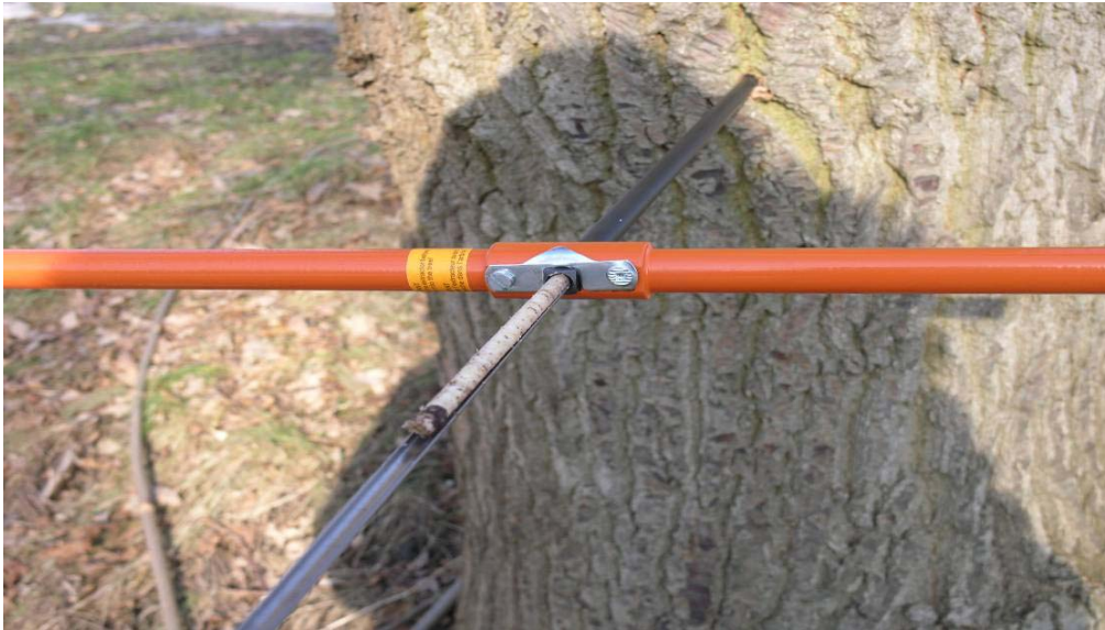
Figur 1. Udtagning af trækerneprøve med trækernebor
