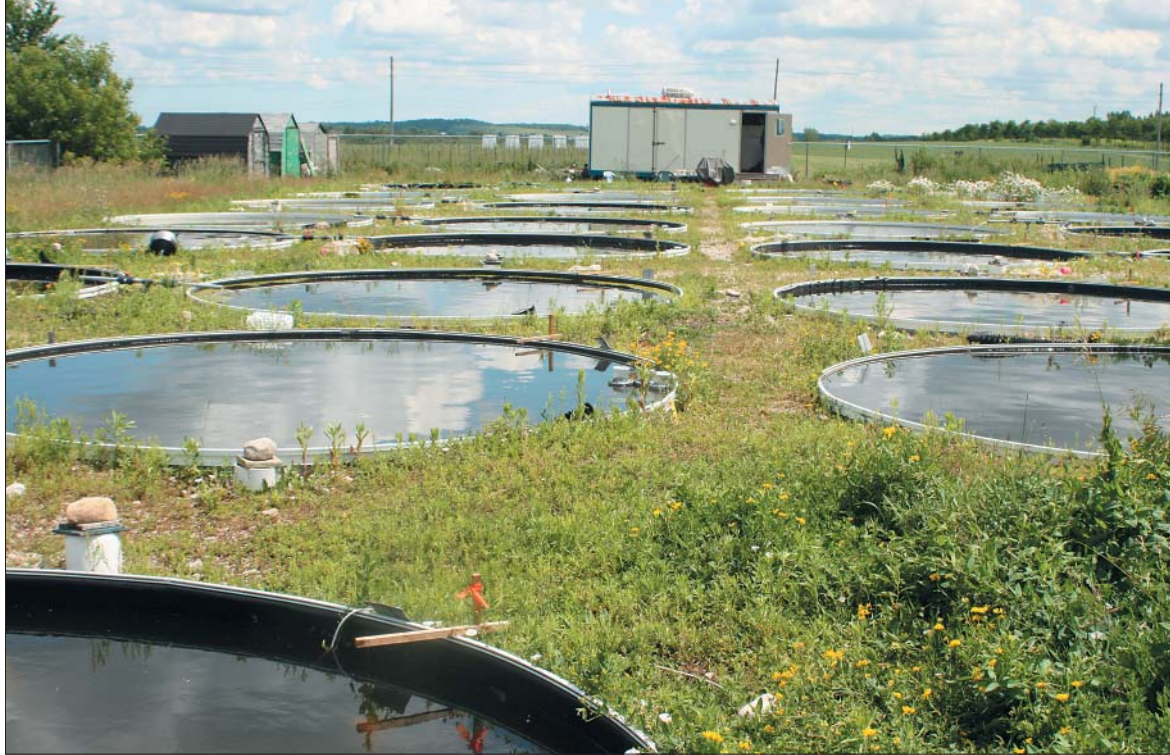
De akvatiske mikrokosmer i Guelph, Canada, består af en lang række kunstige søer, som man kan behandle med forskellige doser af kemikalier. Derefter kan man følge effekterne på et natur-nært vandmiljø.
